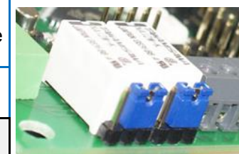
Контакты реле PAS нормально замкнуты
